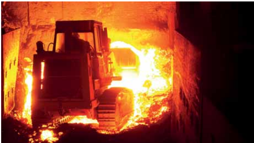
Toolox 44 Hot slag bucket
